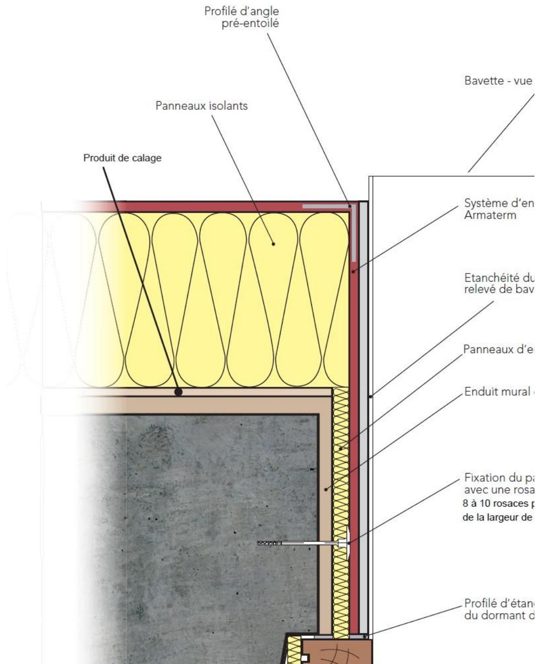
**Figure 2a : Mise en œuvre des panneaux d'embrasure dans le cas d'une rénovation (enduit existant)**
